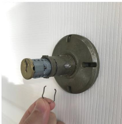
⑤画像のように 固定用パーツが外れます。
