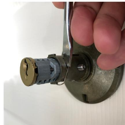
③マイナスドライバーを 画像下方向に押し込んで 固定用パーツをずらします。
